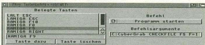
Herantasten: Mit »FKey« ist es leicht, bestimmten Tasten Programme zuzuordnen und somit schnell zu starten
